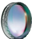
**Filtro UHC/LPR de 3,18 cm (1,25 pulg.) (N° 94123):** Este filtro está diseñado para mejorar las observaciones de objetos astronómicos en el espacio profundo desde zonas urbanas. Reduce selectivamente la transmisión de ciertas longitudes de onda de luz, especialmente aquellas producidas por las luces artificiales. Sólo para el 60AZ, 70AZ y 76AZ.
