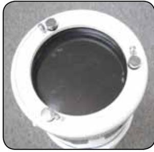
ESPEJO PRINCIPAL. LOS TORNILLOS GRANDES SON PARA LA COLIMACIÓN Y LOS PEQUEÑOS PARA ASEGURAR EL ESPEJO EN SU LUGAR. cada uno. Normalmente, aflojándolos 1/8 de vuelta puede ser suficiente y 1/2 ó 3/4 de vuelta es lo máximo que se necesita para los tornillos grandes de colimación. Gire los tornillos de colimación de uno en uno, y con una herramienta u ocular de colimación vea cómo la colimación es afectada (vea el siguiente
